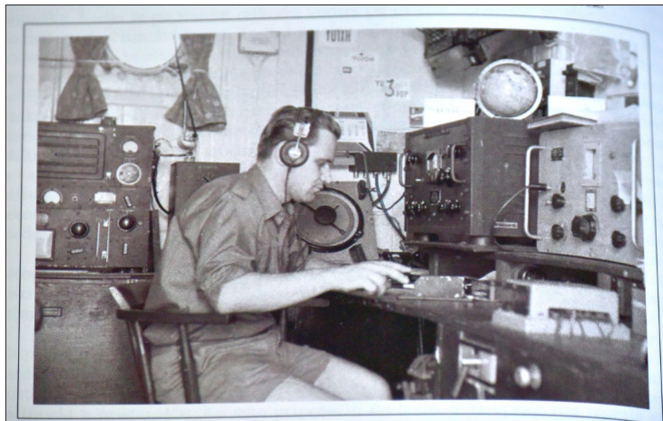
Radijska postaja YTCG na Gorici. Najprej je imela le srednji val. Med vojno so vgradili še kratki val: BC -191, oddajnik in BC -312, sprejemnik (ameriške medvojne izdelave za vojaške potrebe).
