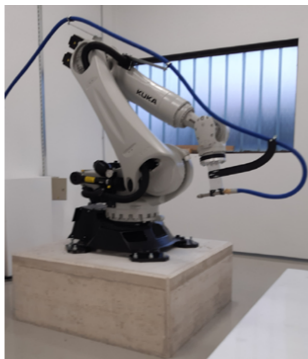
Slika 8b: Elementi ekstruzijskega tiskalnika ZAG: robotska roka, fotografija: Arhiv ZAG.
