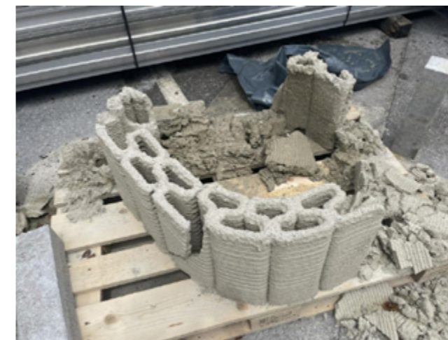
Slika 21: Porušitev objekta iz gline zaradi neustrezne nege, fotografija: Arhiv ZAG.
