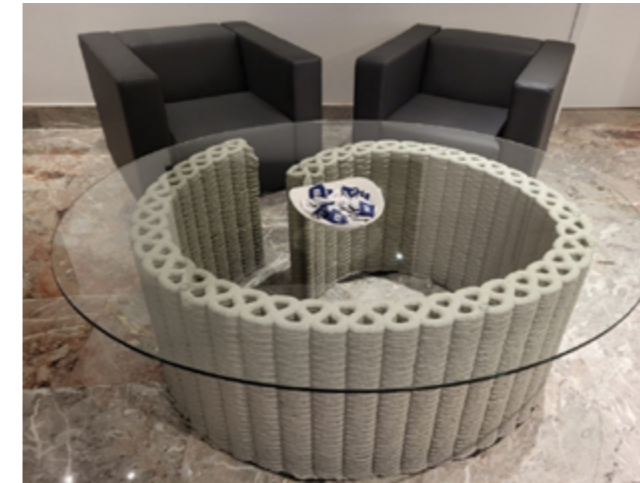
Slika 20: Miza s podstavkom, natisnjen z ekstruzijskim tiskalnikom Kuka in materialom na osnovi cementa, fotografija: Arhiv ZAG.
