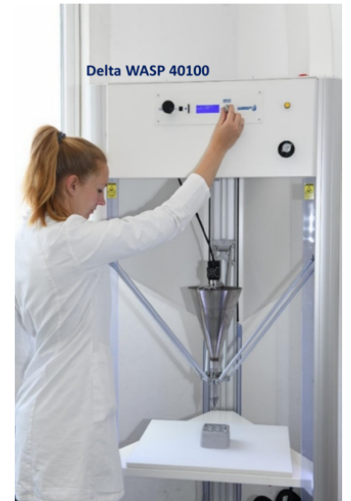
Slika 6: Ekstruzijski tiskalnik WASP 40100, fotografija: arhiv ZAG.
