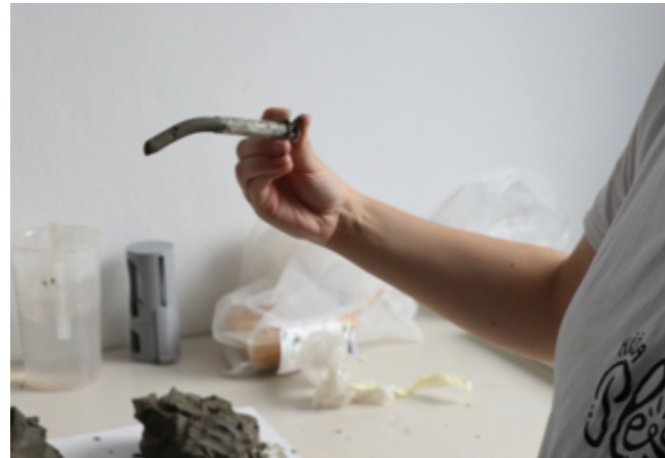
Slika 16: Preprost ekstruzijski test z brizgalko, fotografija: Zala Simčič.
