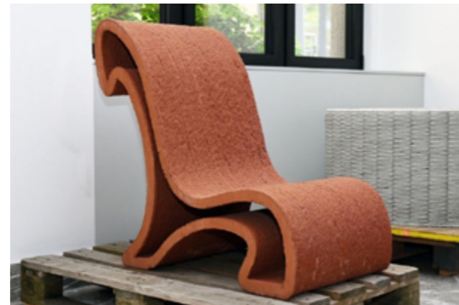
Slika 19: Stol, natisnjen z ekstruzijskim tiskalnikom Kuka in materialom na osnovi cementa, fotografija: Arhiv ZAG.
