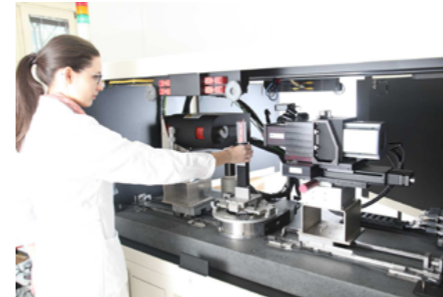
Slika 11: CT scanner na Zavodu za gradbeništvo Slovenije, fotografija: Arhiv ZAG.
