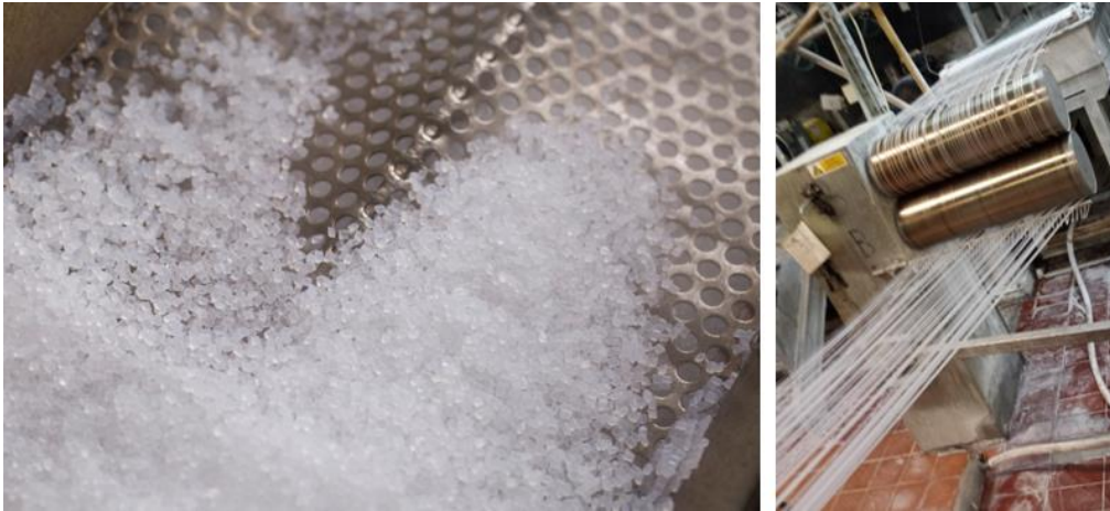
Slika 6: Izdelava granulotov in vlaken
