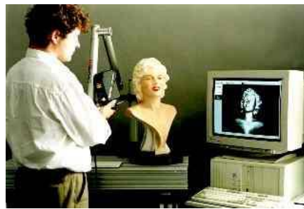
Slika 2: 3D-skener s črtnim načinom in ročnim upravljanjem (Edl idr., 2018)
