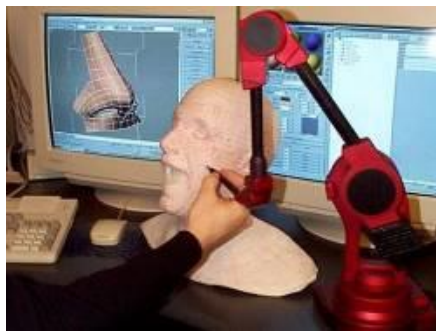
Slika 4: Kontaktno 3D-skeniranje z ročnim vodenjem sonde (ghost3d.com, b. d.)
